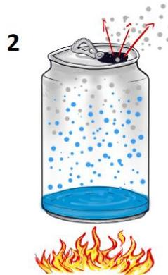
Em seguida, começamos a aquecer a lata, e a água líquida evapora transformando em vapor de água, o que empurra o ar para fora da lata.
